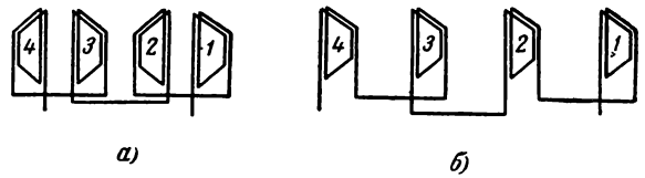
Рис. 10-11. Непрерывная намотка фазы обмотки.
